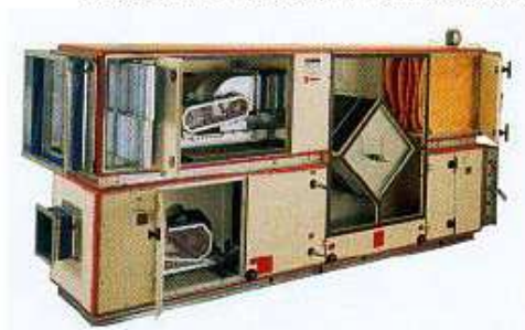
Récupérateur à plaques dans un caisson de traitement d'air
